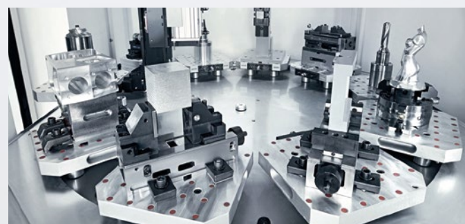
PH 150 - Magazzino pallet da 8 posti portata pari a 250 kg incluso il pallet (in opzione 350 kg)
