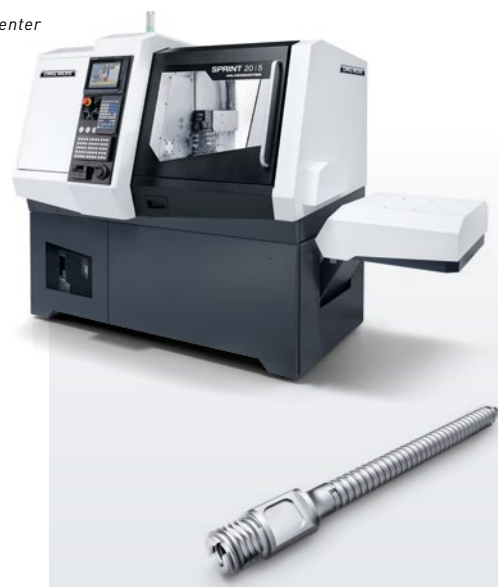
VITE ORTOPEDICA Dimensioni: \varnothing 10 \times 85 mm Materiale: Titanio (Ti6Al4V)
