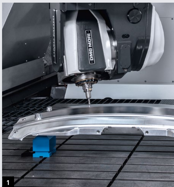
1. Testa portafresa da 45° o 90° per la lavorazione a 5 assi con velocità fino a 30.000 giri/min
