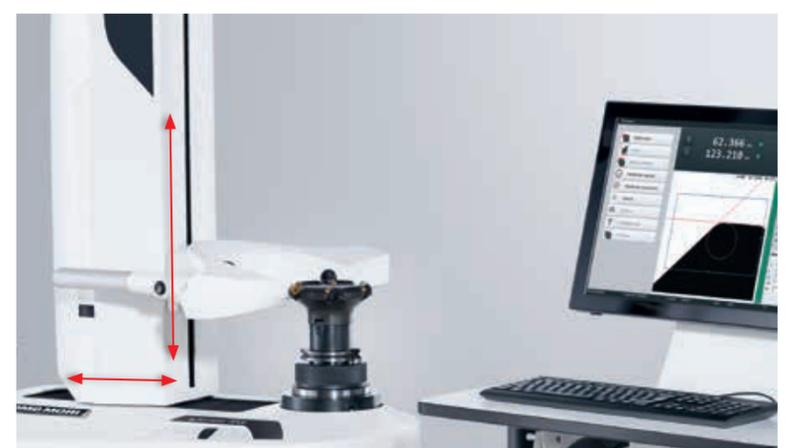
Per il presettaggio e la misurazione completamente automatizzata degli utensili in assenza di errori umani (a controllo CNC, a 3 assi). Con armadietto comfort integrato e display touch da 24" di serie.
