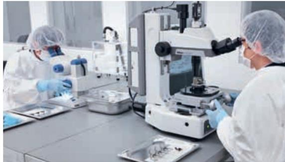
Ora presso lo stabilimento di Wernau: regolazione sensori MR con microscopio da 2 µm di precisione.
