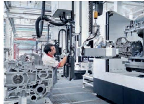
Carico di pezzi nell'area di attrezzaggio. In primo piano una stazione di rotazione e ribaltamento pezzi.
