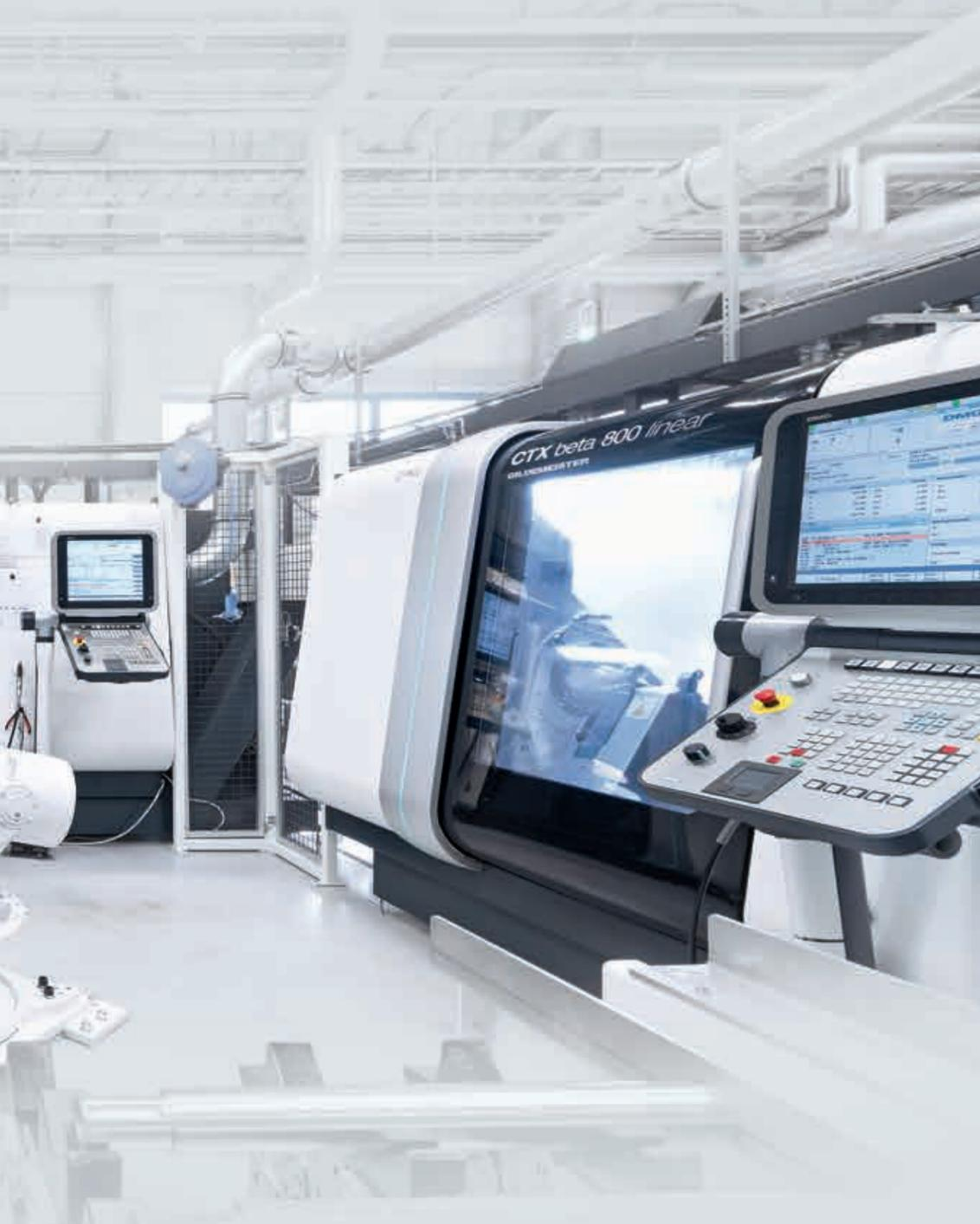
In questa cella di produzione flessibile, la Xylem lavora gli alberi delle pompe per acque reflue – Operazioni di sgrossatura, tornitura, finitura, fresatura di cave e fori. Grazie alla correzione automatica delle quote viene meno la necessità del controllo di qualità finale.
