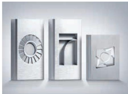
Lavorazione laser di profili 3D ribassati in metallo duro mediante laser a picosecondi.
