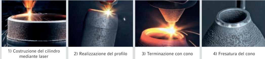
1) Costruzione del cilindro mediante laser
