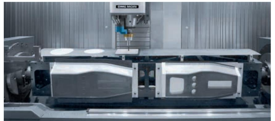
ULTRASONIC 260 con telaio tecnologico integrato e speciale attrezzatura di serraggio pezzo: finitura di superficie di un segmento di pala di rotore; rifilature, fori e tasche di una piastra intermedia in plastica rinforzata con fibre di carbonio (CFRP).
