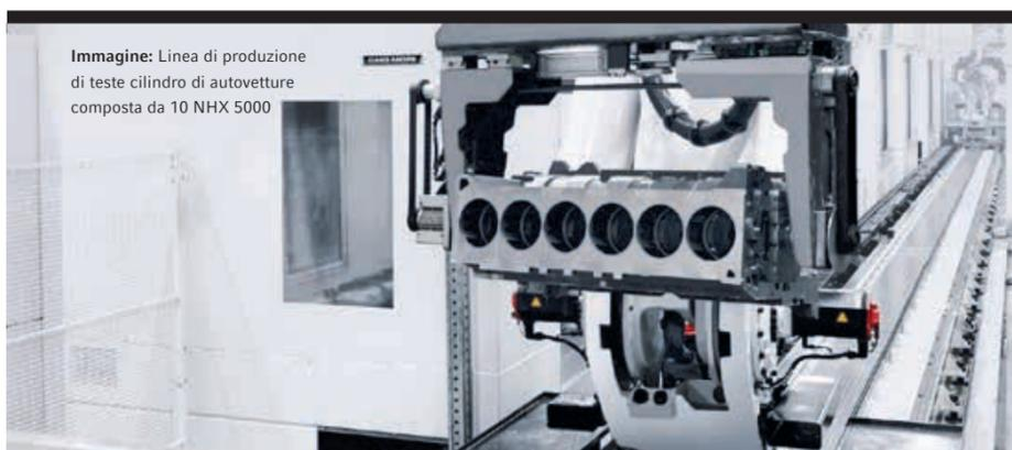
Immagine: Linea di produzione di teste cilindro di autovetture composta da 10 NHX 5000
