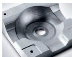
Testurizzazione: struttura a nido d'ape in uno stampo a iniezione di una calotta di volante
