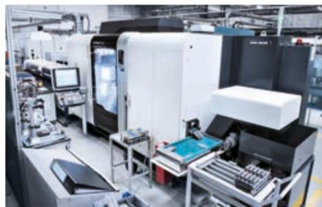
Produzione sulla macchina SPRINT 65 per la massima precisione, con planarità di 0,004 mm.
