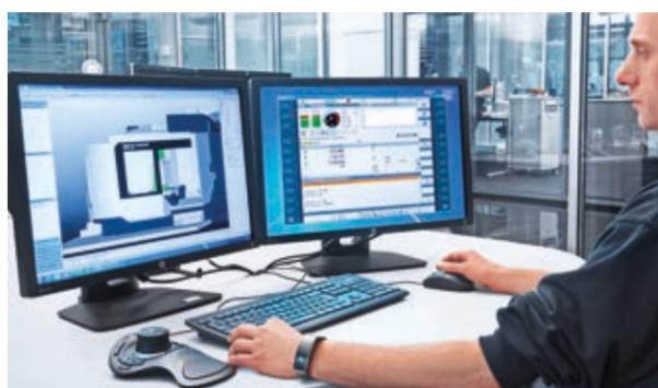
La DMG MORI Virtual Machine è una simulazione 1:1 della DMC 160 H duoBLOCK® incluso il suo controllo numerico effettivo.
