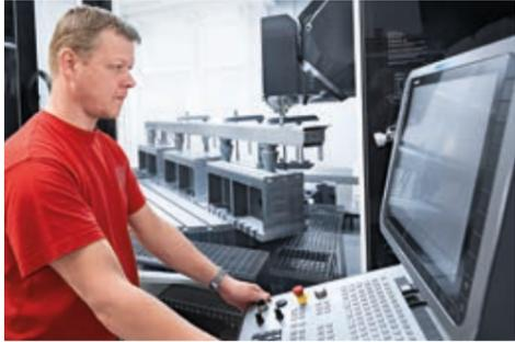
Lavorazione simultanea a 5 assi di pezzi di grandi dimensioni sulla DMU 340 P.
