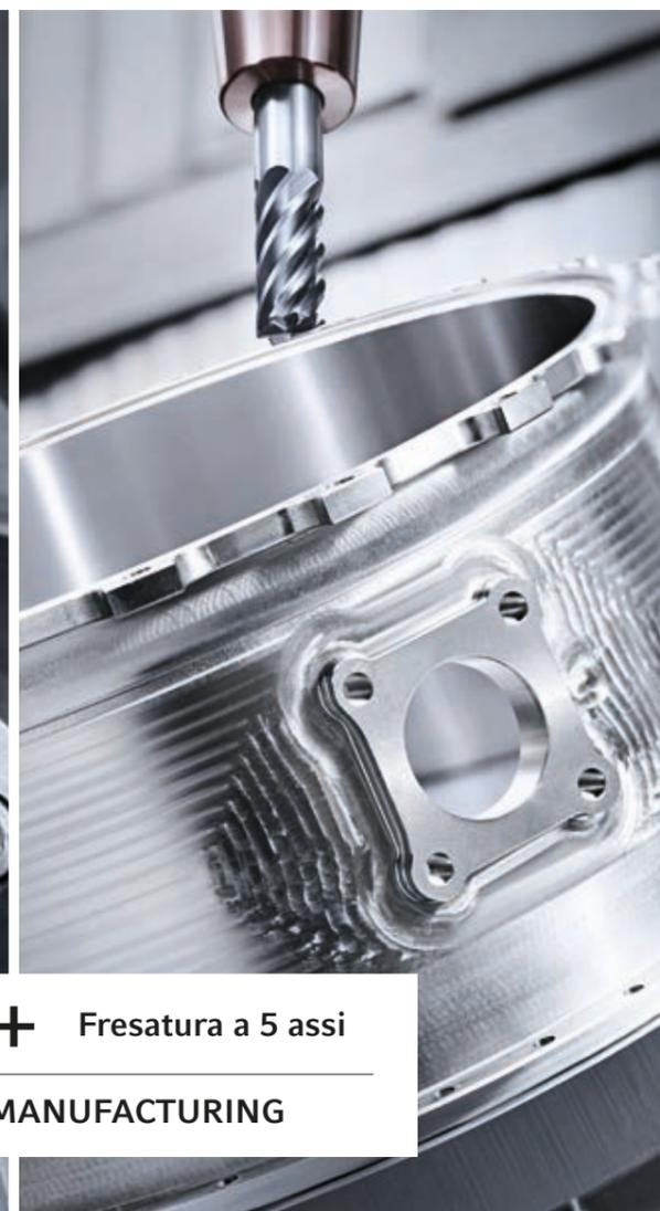
Deposito laser + Fresatura a 5 assi
