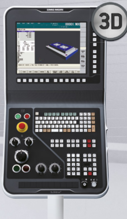
Controllo DMG MORI SLIMline® da 15" con MAPPS IV su FANUC
