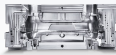
Stampo per paraurti Macchina: DMU 600 Gantry linear Materiale: 21CrNiMo2 Dimensioni: 2.500 x 1.000 x 1.400 mm
