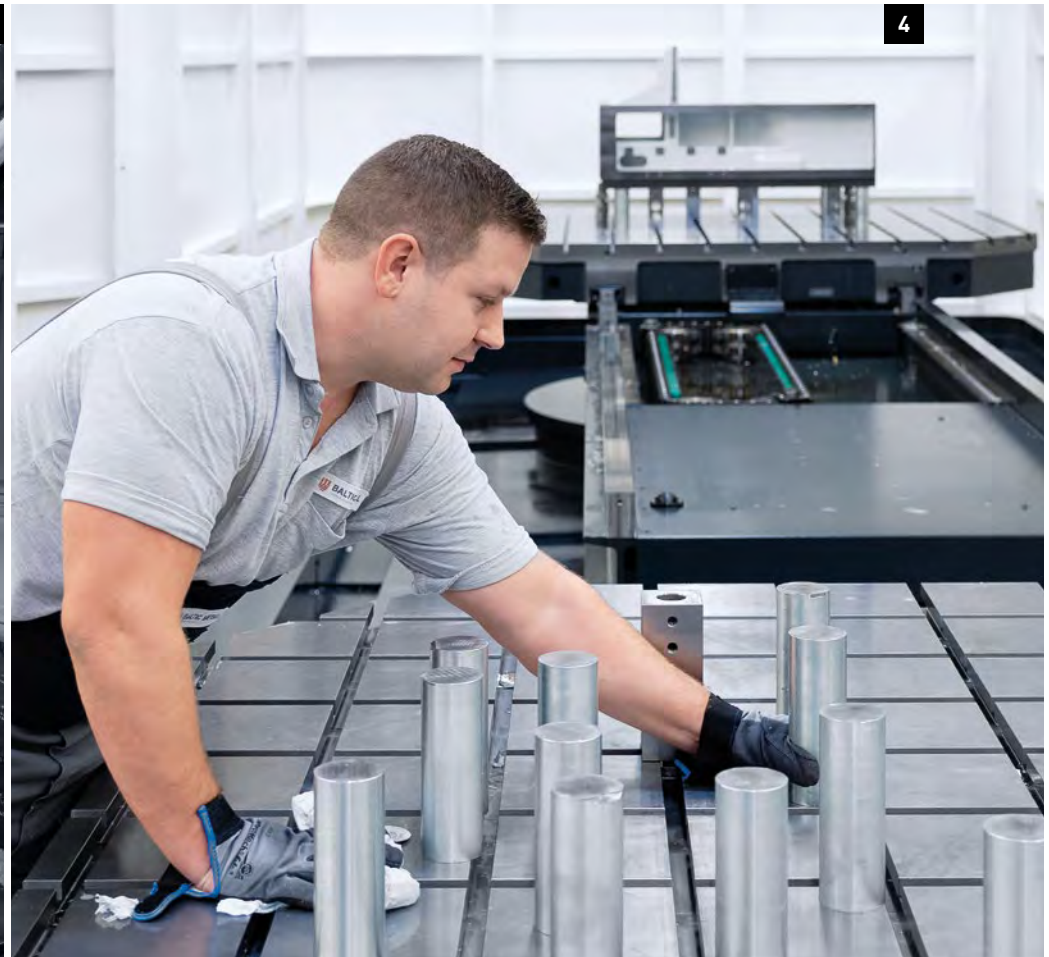
1. Thorsten Deumlich, Direttore della lavorazione di pezzi di grandi dimensioni di Baltic Metalltechnik GmbH 2./3. Sulla DMC 340 si esegue la lavorazione a 5 assi di componenti macchina complessi d'alta precisione per il Gruppo Hauni. 4. L'operatore Marc Hänel sta attrezzando i pezzi per la lavorazione: la speciale tavola presenta delle particolari scanalature che semplificano l'attrezzaggio.
