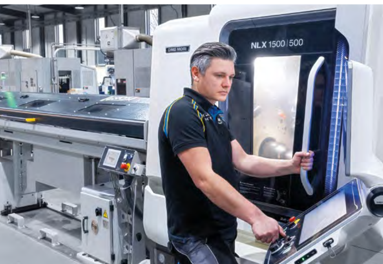
Un solo operatore è responsabile di due NLX 3000 e una NLX 1500 automatizzata con caricatore di barre.
