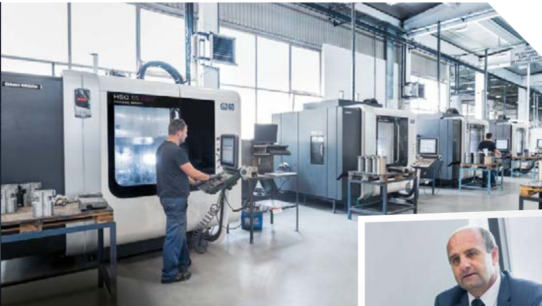
La HSC 55 linear produce stampi complessi in modo preciso ed efficiente.
