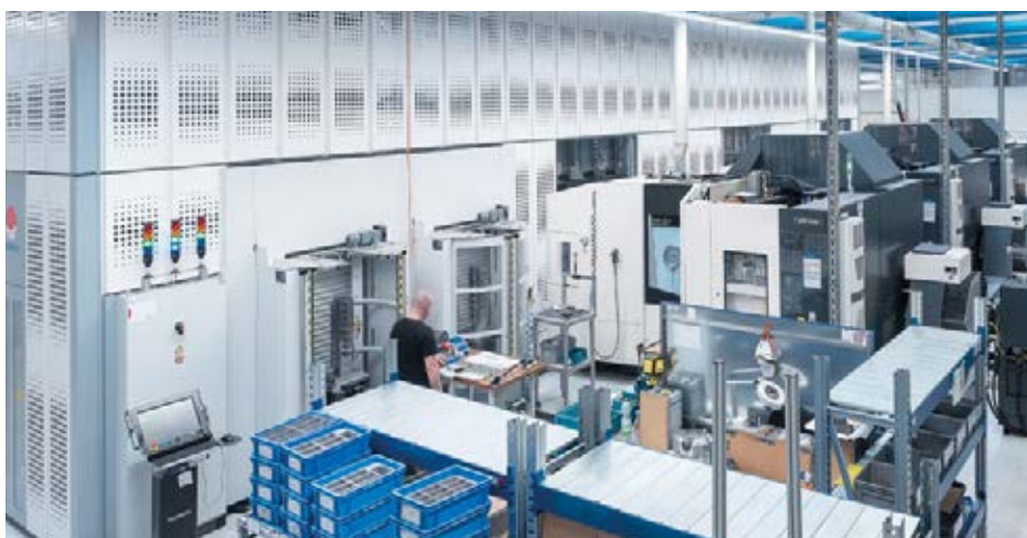
Il più grande degli impianti di automazione finora installati comprende tre DMC 60 H, ciascuna con un magazzino a ruota a 5 compartimenti per 303 utensili.
