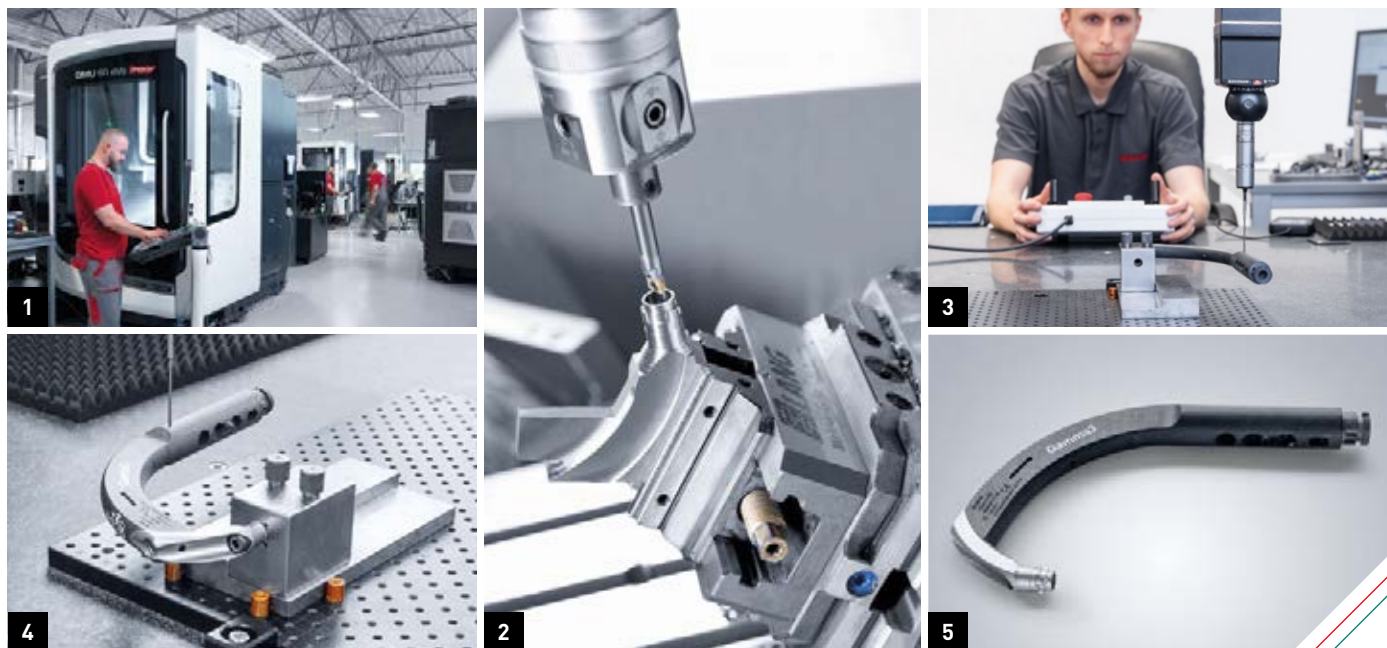
1. La DMU 60 eVo linear installata alla Wenglon nel 2019 è una delle 14 macchine della serie di successo DMU eVo. 2. La Wenglon lavora sulle DMU eVo a 5 assi materiali complessi, come carbonio e acciaio inossidabile. 3. + 4. I prodotti medicali ammettono spesso tolleranze di pochi millesimi. 5. Nell'ottimizzazione dei processi di creazione di componenti complessi e altamente precisi, la Moll Engineering ha già collaborato a stretto giro con il DMG MORI Medical Excellence Center di Seebach.
