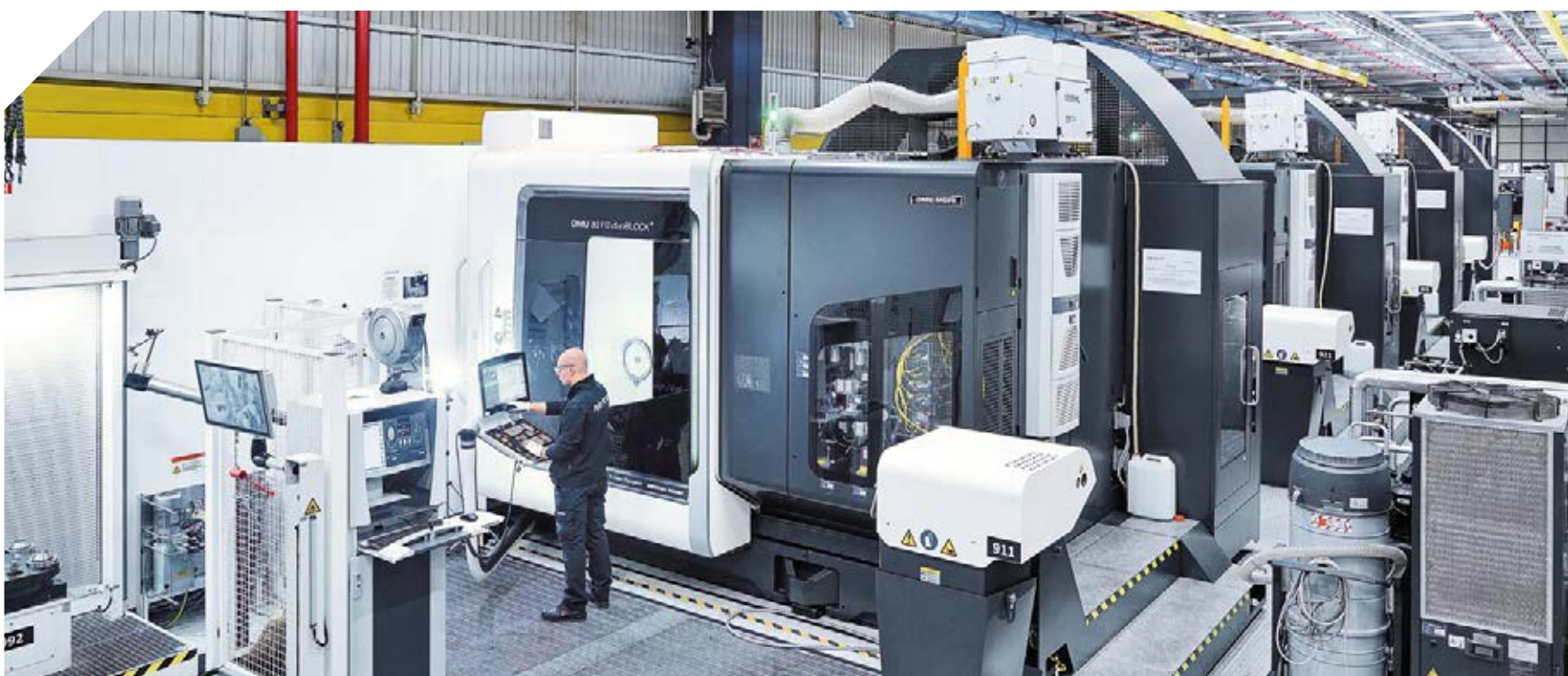
Automazione personalizzata: quattro DMU 80 FD duoBLOCK automatizzate con un unico magazzino pallet.
