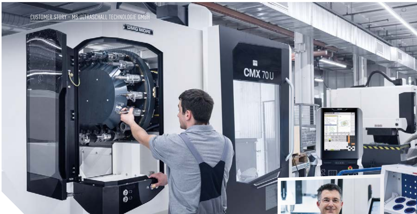
Attrezzaggio in tempo mascherato grazie al magazzino utensili con accesso separato su CMX 70 U.
