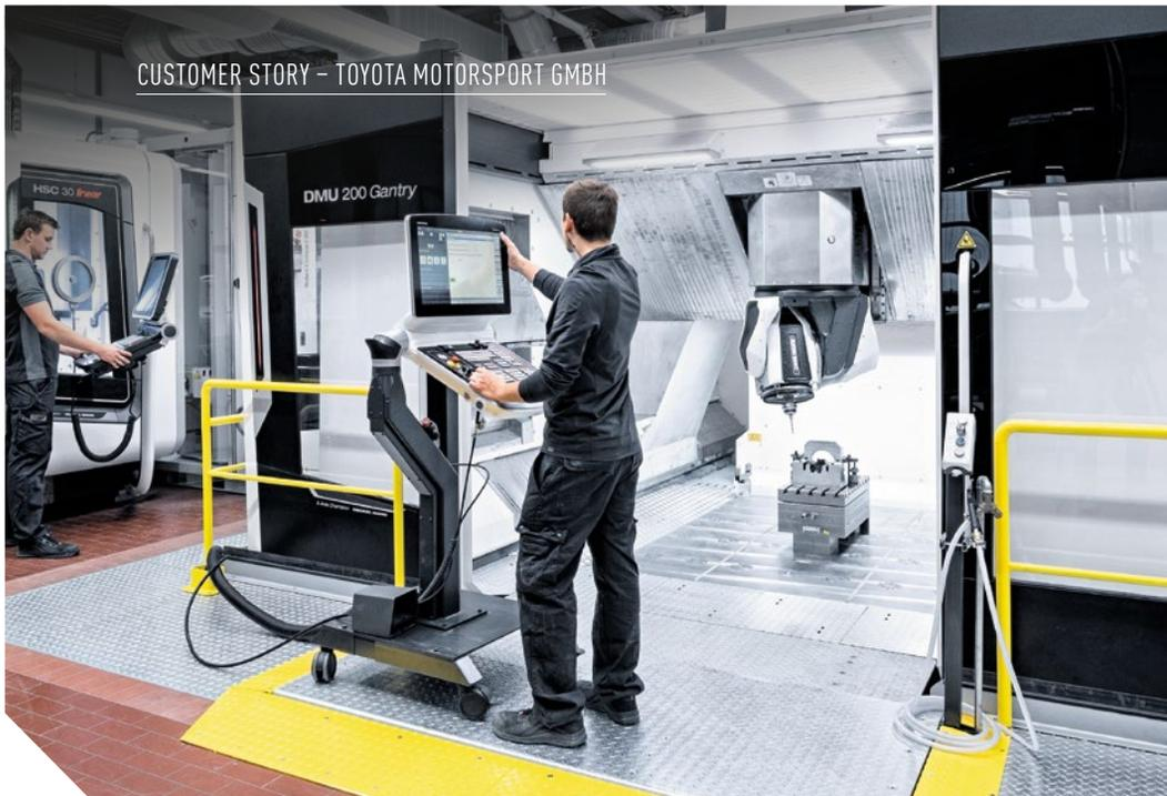
DMU 200 Gantry integrata nel pavimento aziendale per poter caricare e scaricare i pezzi più delicati in carbonio mediante muletto a livello terra.
