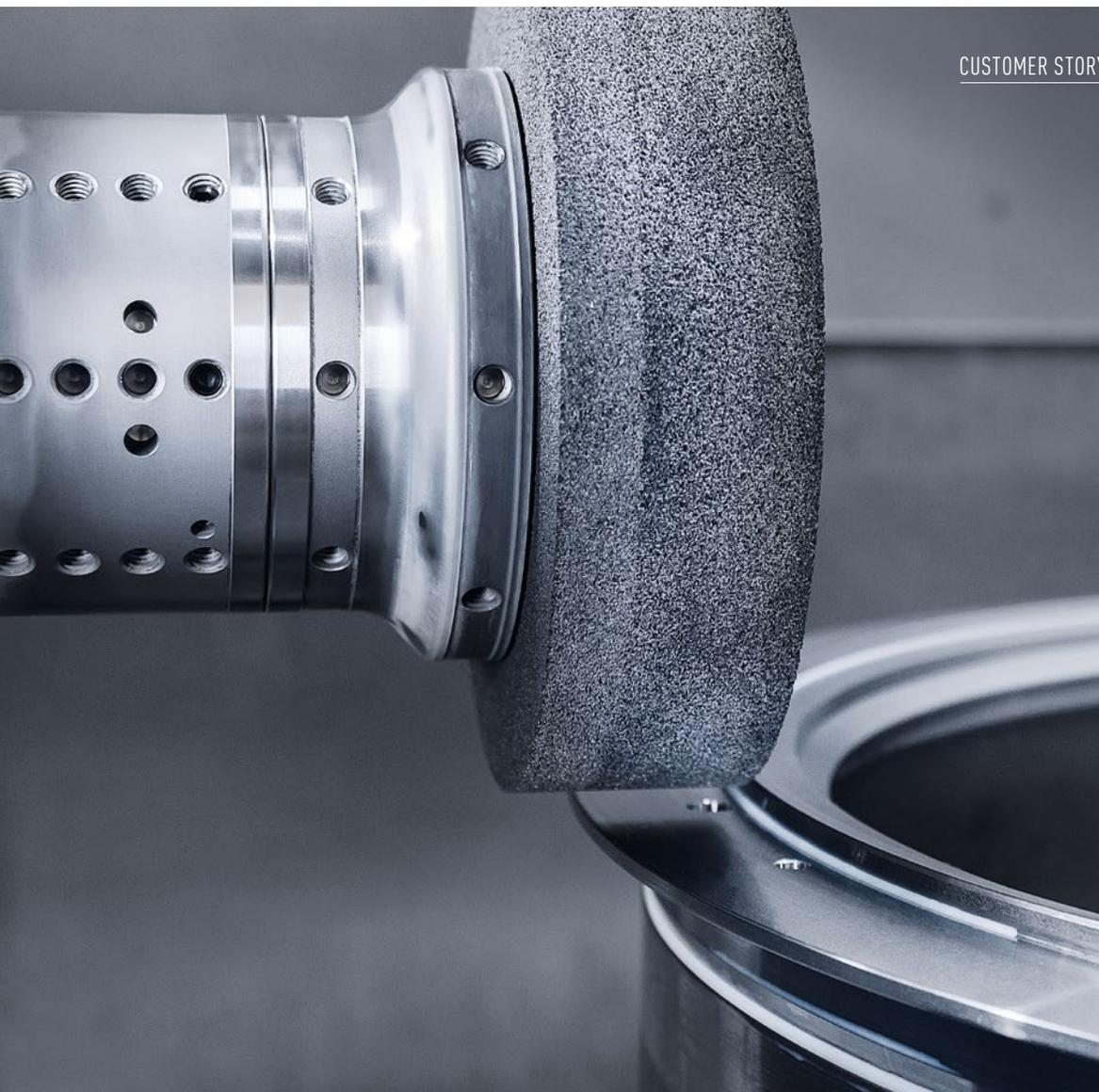
La DMC 125 FD duoBLOCK con pacchetto di rettifica unisce fresatura, tornitura e rettifica in un unico serraggio.
