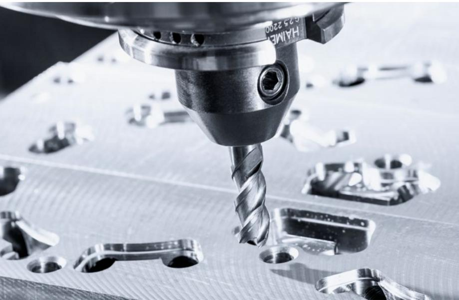
La produzione di stampi per l'estrusione a soffiaggio spazia dalla foratura e fresatura dei punti di raffreddamento, alla sgrossatura, fino alla finitura, richiedendo, dunque, l'impiego di centri di lavoro di applicazione universale.
