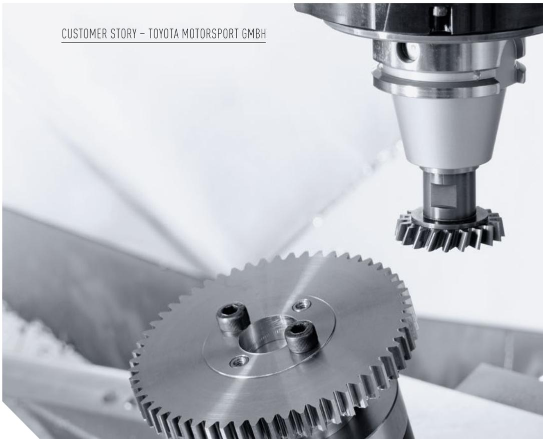
DMG MORI gearSKIVING — Lavorazione di ruote dentate su una DMU 60 eVo con la stessa qualità della rettifica.
