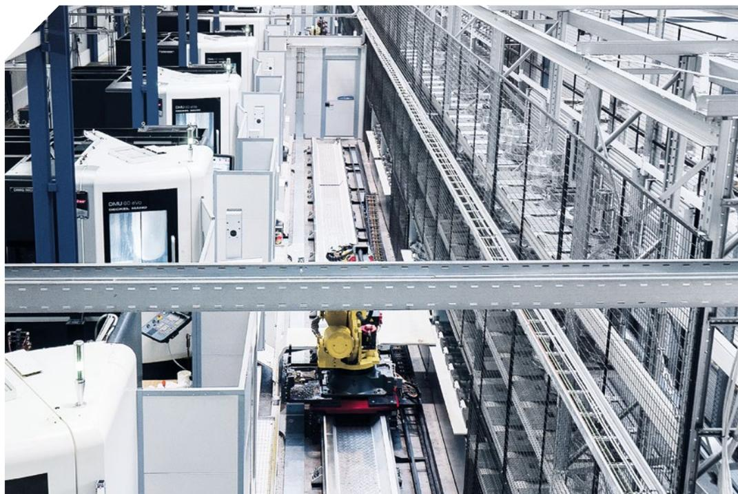
Concatenazione di dodici DMU 60 eVo **linear** mediante magazzino pallet da 743 postazioni presso PFW.
