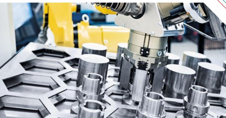
In caso di diametri differenti tra loro, il Robo2Go calcola automaticamente il punto centrale di ciascun pezzo, in modo tale da afferrarlo con assoluta precisione.
