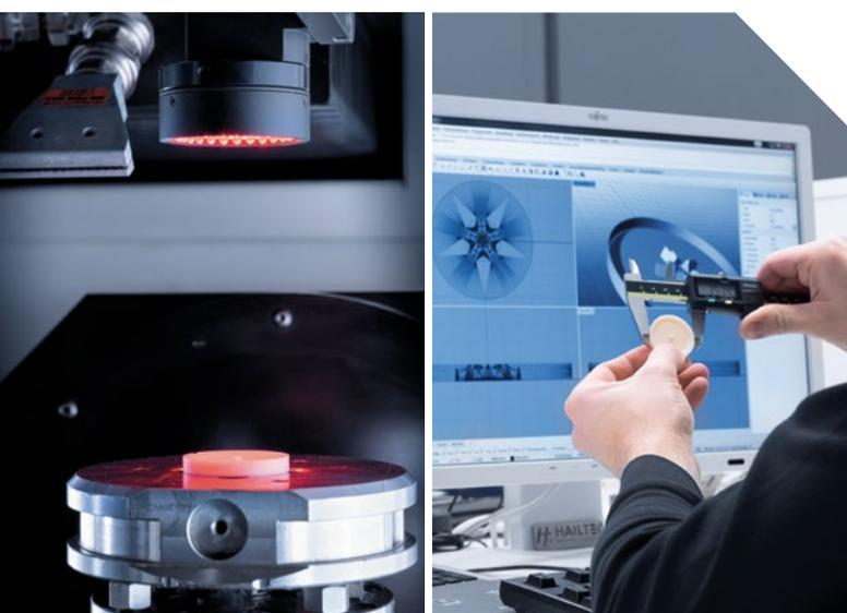
La LASERTEC 50 Shape esegue applicazioni che prima erano possibili solo con processo di elettroerosione.
